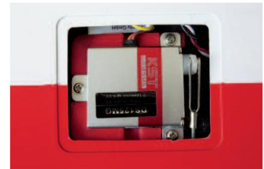
tenruderservo verschwindet dabei zur Hälfte in der Seitenruderdämpfungsflosse. Ich hoffe, dass es lange störungsfrei funktioniert. Ansonsten muss für die Schraube des verdeckten Befestigungsflansches eine Öffnung in die Seitenruderdämpfungsflosse gefräst werden.
